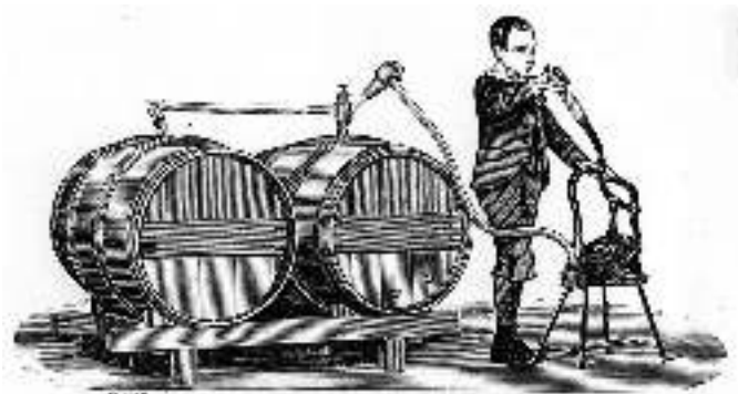
Fig. 20. — soufflet à alcool à air comprimé, pour transformer les vins oxygénés. Trazzi
