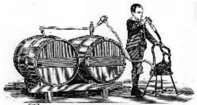
Fig. 20. — soufflet à alcool à air comprimé, pour transformer les vins oxygénés. T. 224.
